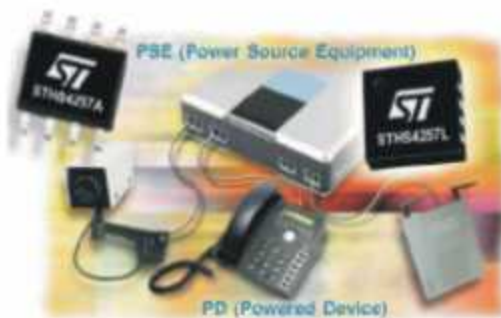
STHS4257控制器在PoE以太网供电中的应用
